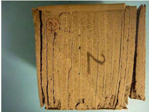
Figur 8: Brud ved tryk parallelt på fibrene
