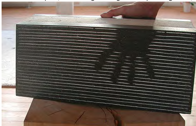
Figur 16: Billeder fra Lucon.com, hvor man kan se den gennemskinnelige beton med isolering.
