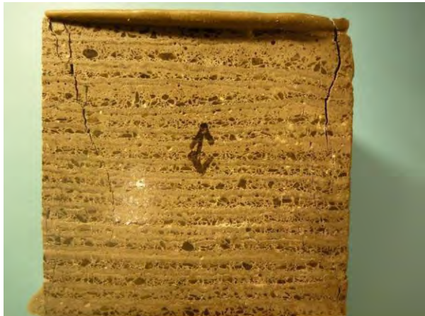
Figur 7: Brud ved tryk vinkelret på fibrene
