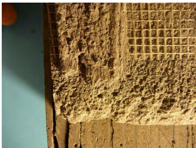
Figur 5: Billede af optiske fibre, som er placeret oven på måtten som styrer retningen på fibrene.
